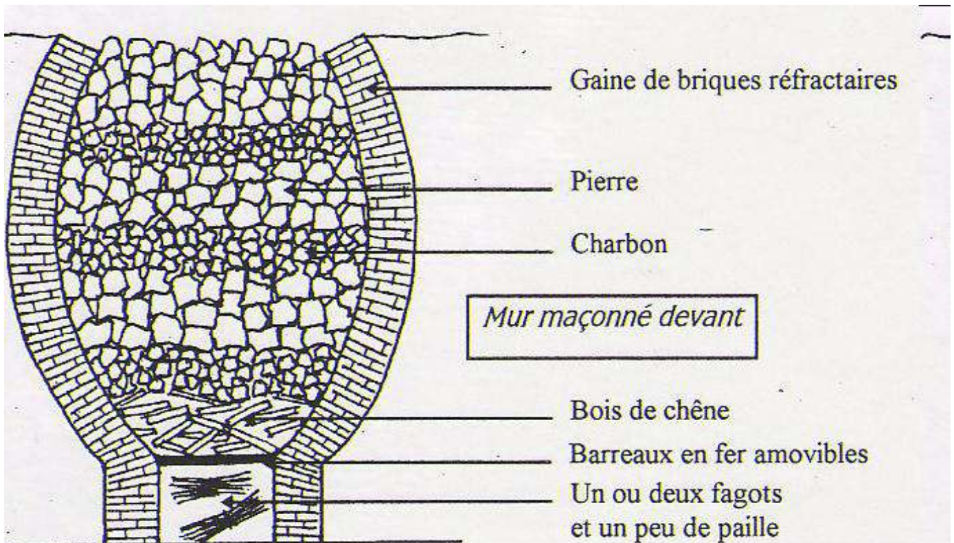
Coupe verticale expliquant le chargement d'un four à chaux. Dessin Henri Donzaud, d'après Anciennes tuileries dans la région de Gençay .
