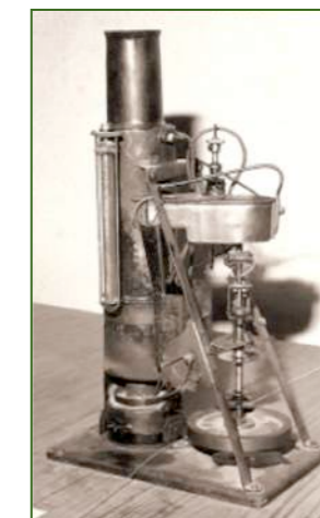
Petite chaudière à vapeur destinée à actionner un « pick-up »
